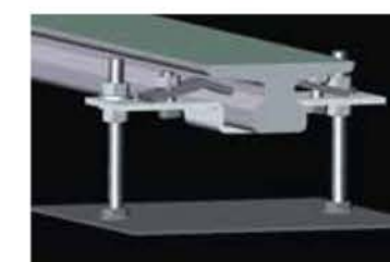
Detalle Perfil Guía (normalizado A-45). Detail Guide Rail (Standard A-45).
