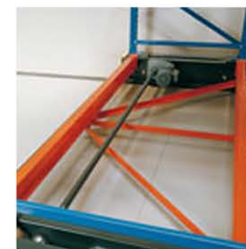
Motor y eje de tracción. Motor and drive shaft.
